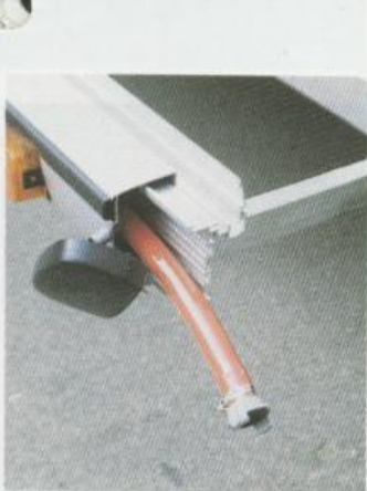
Abwässerschlauch – hygienisch in der Heckstoßstange untergebracht. Anschlußkupplung für Abwassertank.
