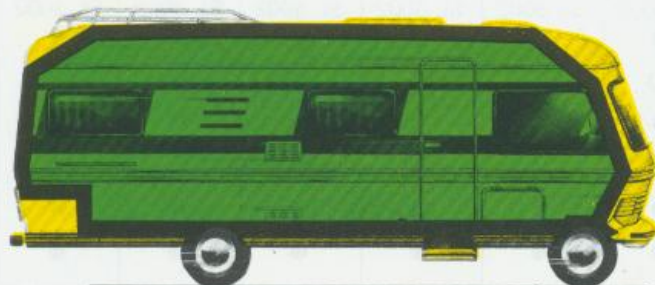
Sicherheit – Fahrgastraum im Hymermobil, vorn und hinten Knautschzonen.
