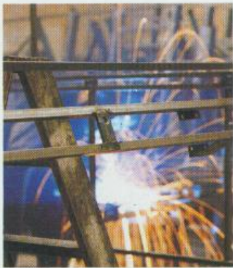
geschweißter Stahlrohrrahmenteil des Hymermobils.
