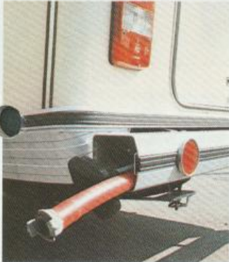
Abwasserschlauch – hygienisch in der Heckstoßstange untergebracht. Anschlußkupplung für Abwassertank.
