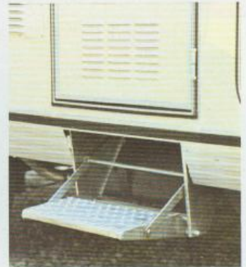
von innen bedienbare Trittstufe (in Hytermobilen).
