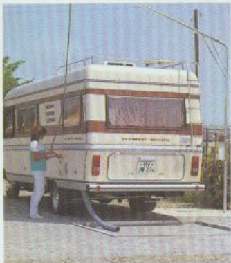
Frischwasser- und Abwasserentsorgung an der Eriba-Hymer-Sanitärstation in Bad Waldsee.
